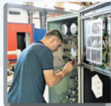
Измерительный комплекс на базе хроматографа МАГ для анализа компонентного состава газообразных продуктов пиролиза
